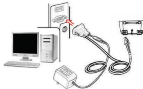
Conexão Serial RS232
